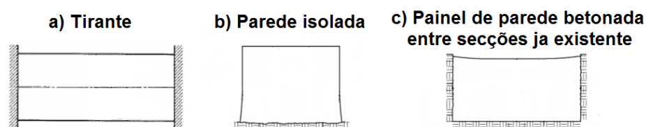
Figura 4.1 – Condições de fronteira para o caso de: a) tirante; b) parede isolada; c) painel de parede betonada entre secções já existentes. Adaptada de EN1992-3 [21]
