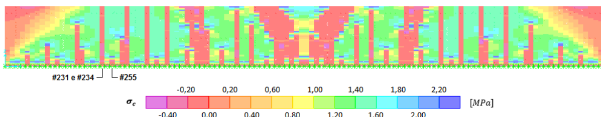
Figura 5.31 – Tensão no betão no instante em que se forma a fenda no elemento #255 ( \Delta T = -37,8^\circ\text{C} ), para o caso 4
