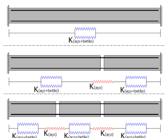
Figura 2.10 – Evolução da rigidez ( K ) do elemento ao longo do seu comprimento à medida que este fendilha [5]
